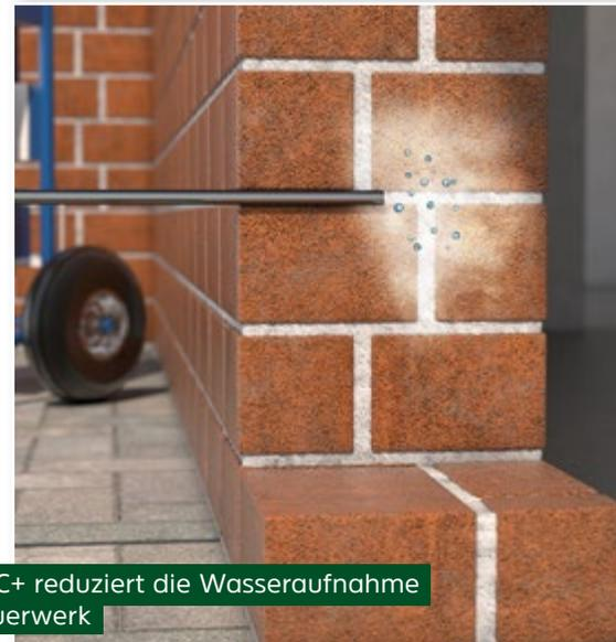
Kiesel C+ reduziert die Wasseraufnahme im Mauerwerk
