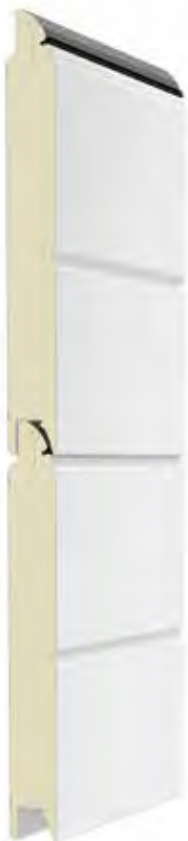
Die doppelwandigen Torlamellen der Garagen-Sektionaltore sind mit PU-Schaum gefüllt und sorgen für eine hohe Dämmung, z. B. beim LPU 42 mit 42 mm starken Lamellen.
