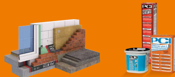
SYSTEM BAUWERKSABDICHTUNG ZWEISCHALIGES MAUERWERK
